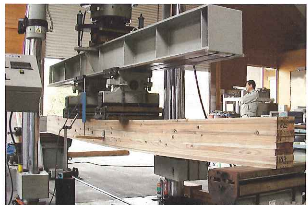
写真1 圧密ラミナを複合した集成材の実大曲げ試験
