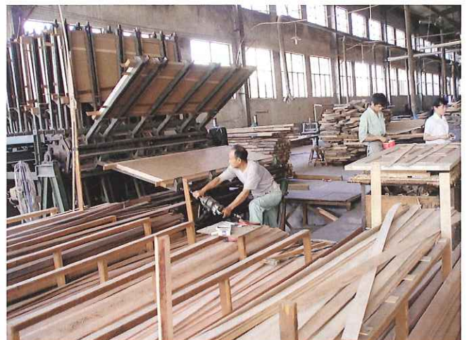
写真12 ドア枠の組み立て
